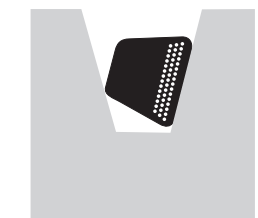
"Virada" da correia na polia Giro de la correa en la polea.
